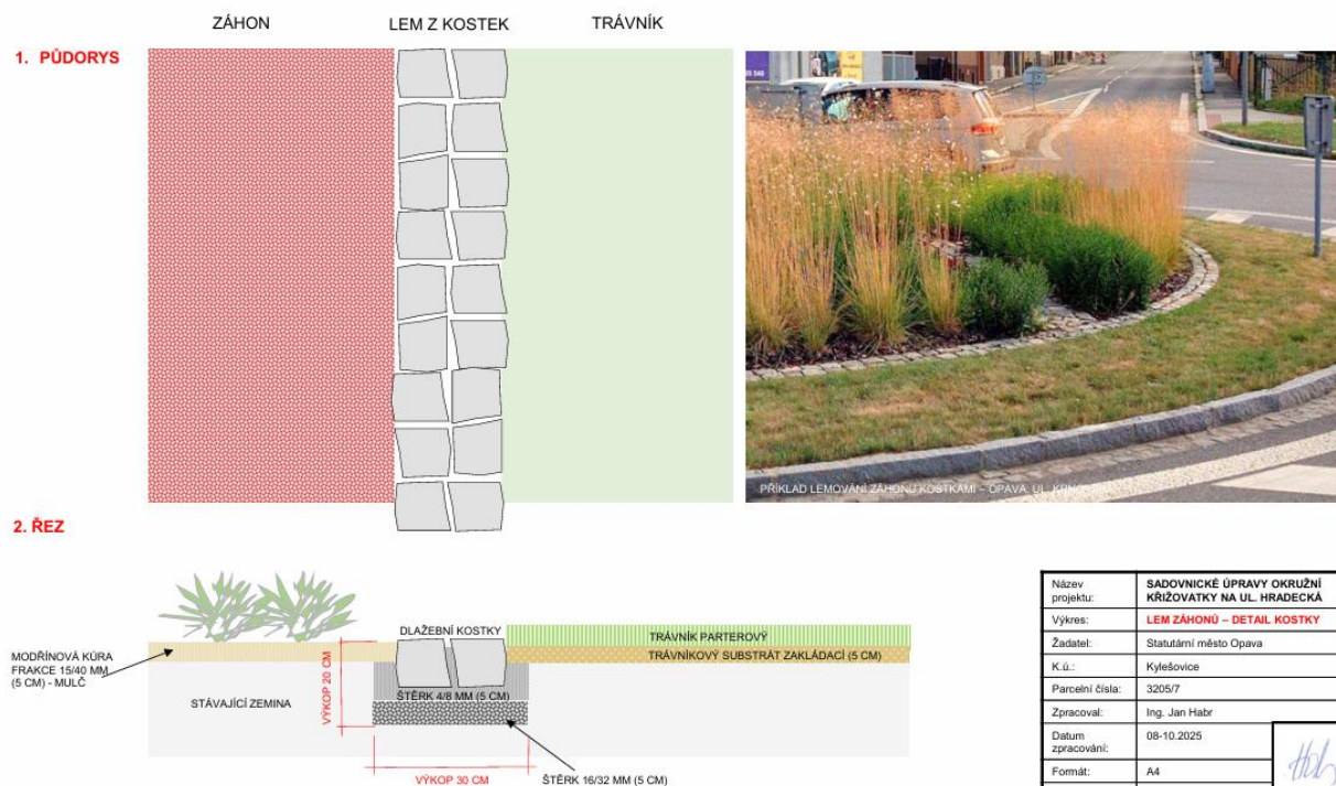
Obr. 7 – Obruby záhonů, detail uložení kostek
